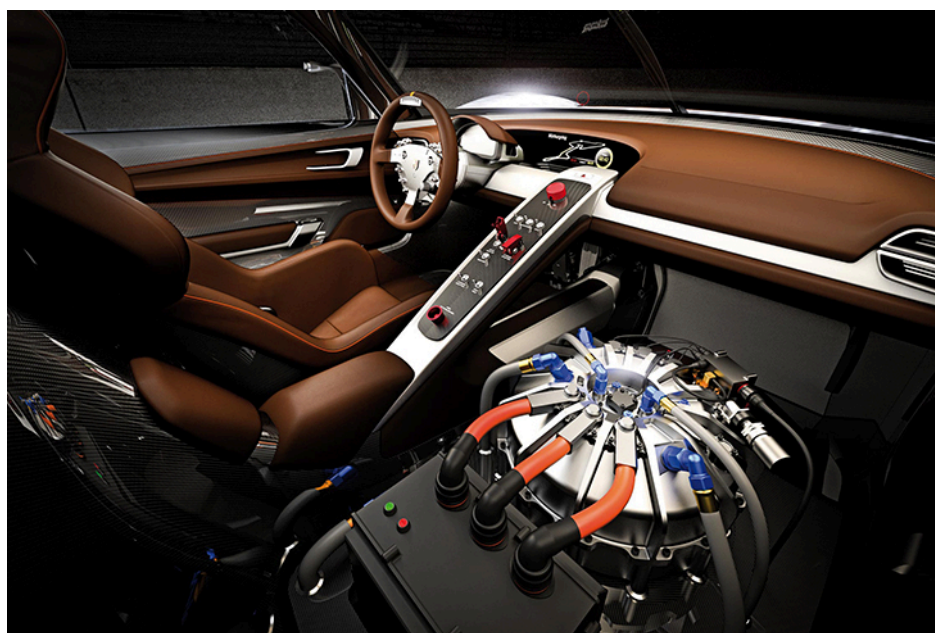
Rysunek 10.18 Na fotelu pasażera umieszczono urządzenie wykorzystujące koło zamachowe do odzyskiwania energii kinetycznej w samochodzie. (Źródło: „cmonville”/Flicker)
