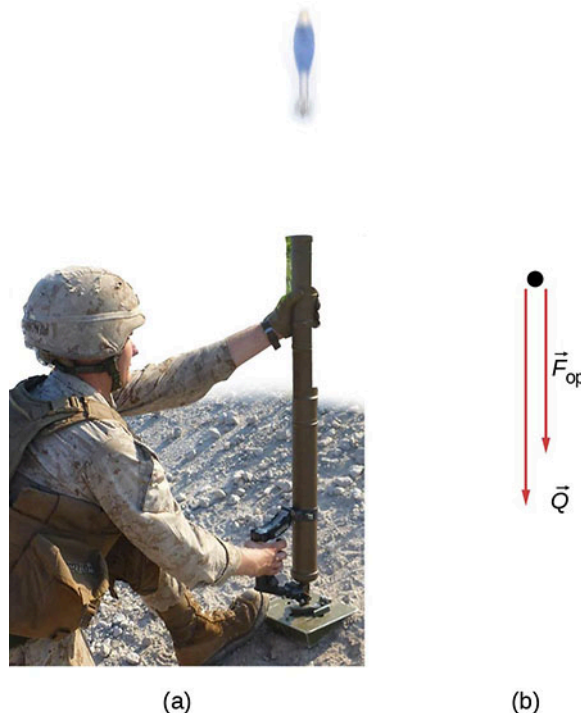
Rysunek 6.9 (a) Pocisk moździerzowy jest wystrzeliwany pionowo w górę. Uwzględniamy siłę oporu powietrza działającą na pocisk. (b) Rozkład sił działających na pocisk w ruchu.
