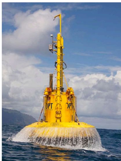
Rysunek 16.1 Z badań nad odnawialnymi źródłami energii wywodzi się koncepcja boi wytwarzającej prąd elektryczny. Opracowano wiele wersji tego urządzenia. Model pokazany na rysunku przekształca energię ruchu boi w płaszczyźnie pionowej (tj. w górę i w dół) i poziomej (tj. z boku na bok) w energię ruchu obrotowego. W ten sposób uruchomiony zostaje generator prądu elektrycznego. Energia elektryczna magazynowana jest w baterii.
