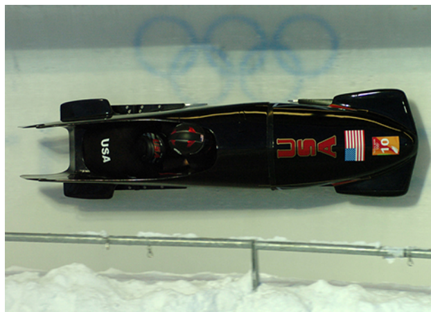
Rysunek 6.29 Posiadanie aerodynamicznego kształtu jest kluczowym zagadnieniem dla wielu pojazdów: od samochodów wyścigowych po sanie bobslejowe, gdyż pomaga osiągnąć najwyższe prędkości. Na przykład bobsleje zazwyczaj mają kształt pocisku ze zwężającymi się statecznikami. (Źródło: "U.S. Army"/Wikimedia Commons)
