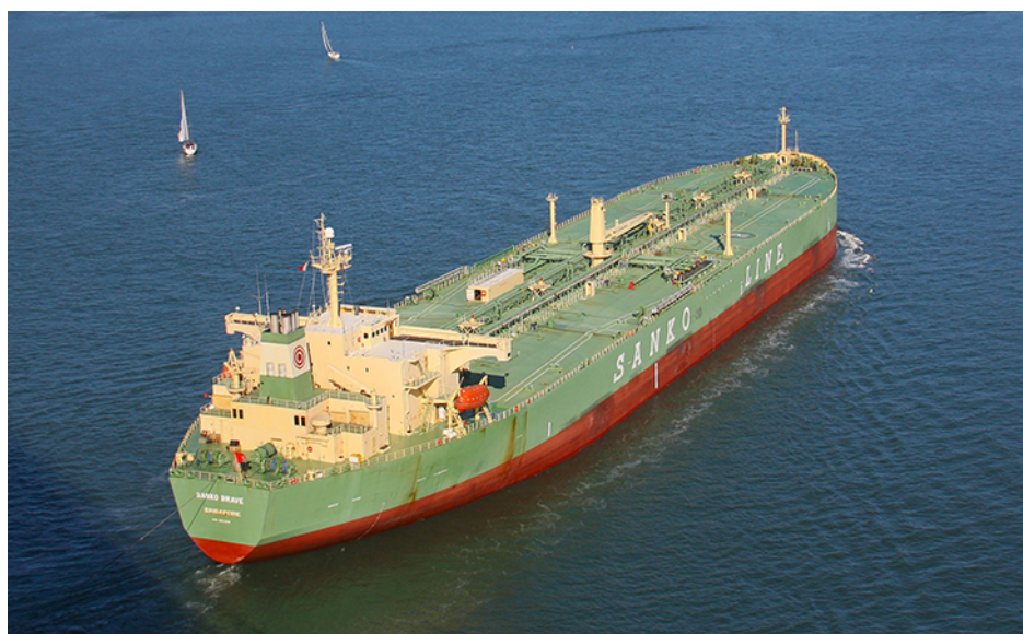
Rysunek 9.4 Supertankowiec przewożący ogromne ilości ropy naftowej ma niemal 400 metrów długości, ponad 60 metrów szerokości, masę 500 tysięcy ton i rozwija prędkość do 30\text{ km/h} . Ze względu na znaczną bezwładność zmiana stosunkowo niewielkiej prędkości statku wymaga długiego czasu – rzędu kilkunastu do kilkudziesięciu minut. (Źródło: zmodyfikowane przez „the_tahoe_guy”/Flickr)
