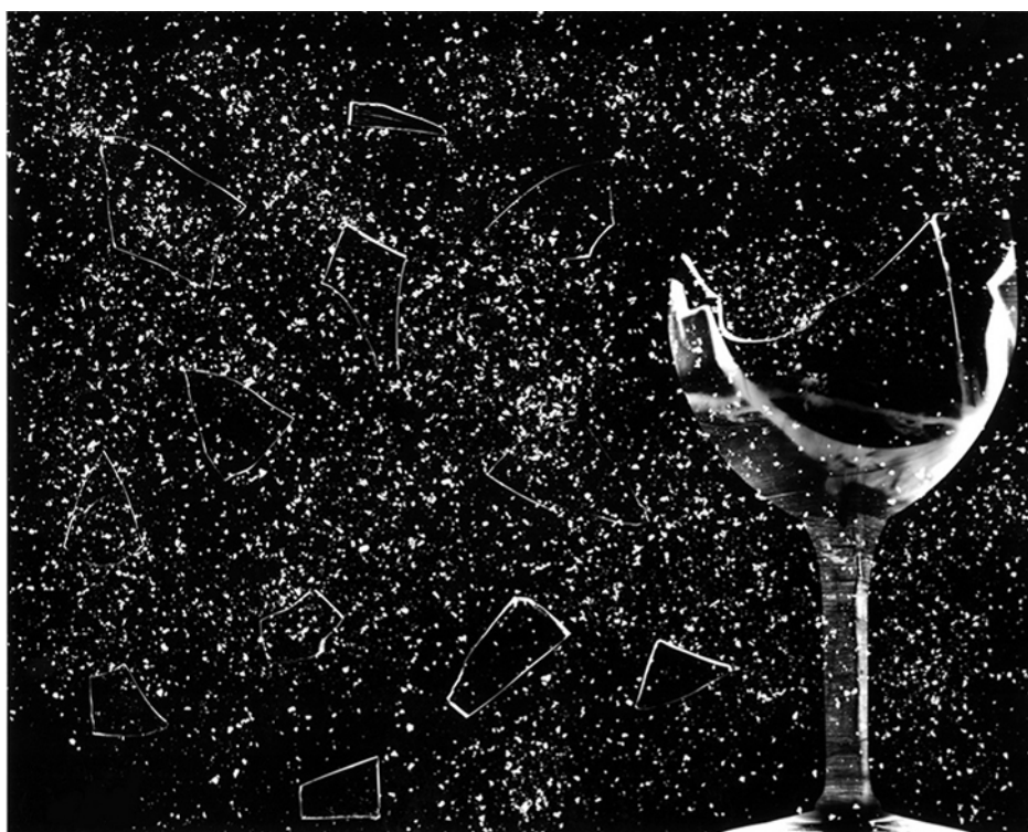
Rysunek 17.2 Kieliszek rozbiła fala dźwiękowa o częstotliwości równej częstotliwości rezonansowej kieliszka (Źródło: „||read||”/Flickr)
