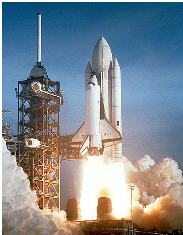
Rysunek 9.32 Prom kosmiczny wykorzystuje zarówno paliwo stałe, jak i ciekłe i wyposażony jest w sporą liczbę elementów wielokrotnego użytku. Ogromne zbiorniki na paliwo ciekłe przeznaczone są wprawdzie na straty, ale dodatkowe zbiorniki na paliwo stałe odzyskuje się i powtórnie napełnia po każdym locie. Również sam statek po powrocie na Ziemię wykorzystywany jest do kolejnych lotów. Umożliwiają to m.in. pokrywy ceramiczne chroniące go przed przegrzaniem podczas powtórnego wejścia w atmosferę. Można zatem wielokrotnie powtarzać misje wahadłowca. (Źródło: NASA)
