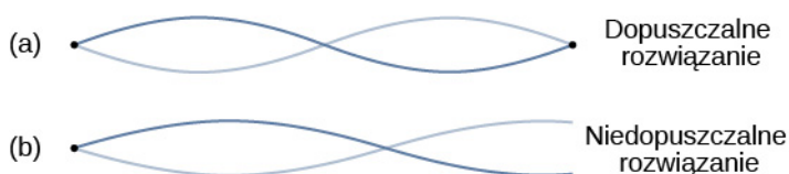
Rysunek 16.31 (a) Rysunek przedstawia drugi mod struny, który spełnia warunki brzegowe, zgodnie z którymi na obu końcach struny powstają węzły. (b) Ta sytuacja jest niedopuszczalna, gdyż nie zostałyby utworzone mod normalny ze względu na niespełnienie warunków brzegowych. Na jednym końcu występuje węzeł, a na drugim strzałka.
