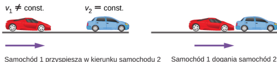
Rysunek 3.25 Przykładowa realizacja zagadnienia pogoni, gdzie samochód 2, jadący ze stałą prędkością, jest ścigany przez samochód 1, który porusza się ze stałym przyspieszeniem. Samochód 1 dogania samochód 2 po pewnym czasie.
