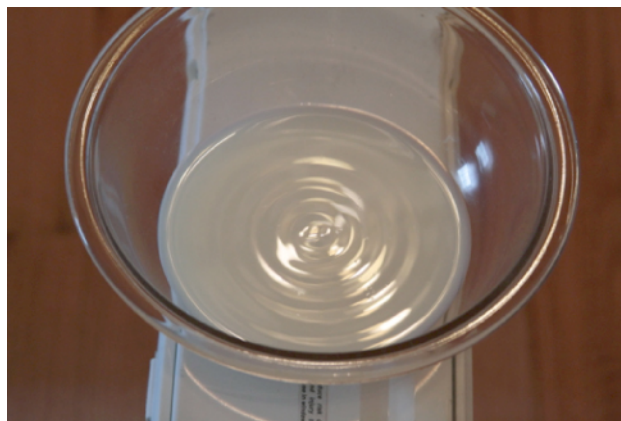
Rysunek 16.25 Fale stojące zostały utworzone na powierzchni mleka w misce, umieszczonej na obudowie wiatraka. Drgania wiatraka powodują, że powierzchnia mleka drga.
